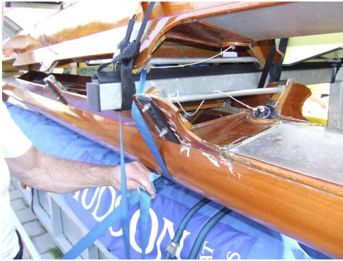
Foto 8: het hangen van een skiff onder de stelling. Let erop dat de boorden niet beschadigen en dat de kiel geen andere boten raakt.
