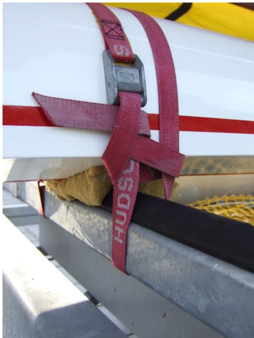
Foto 3: het voortaft van skiffs adequaat afsteunen met schuimrubber en niet te vast aanspannen
