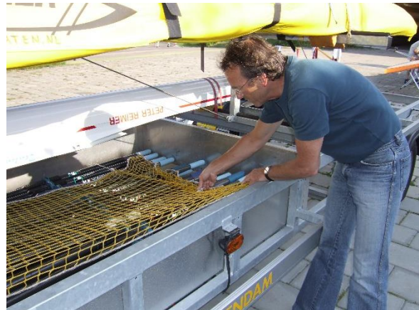
Foto 7: riggers en riemen strak overspannen met net en vasthaken met elastieken
