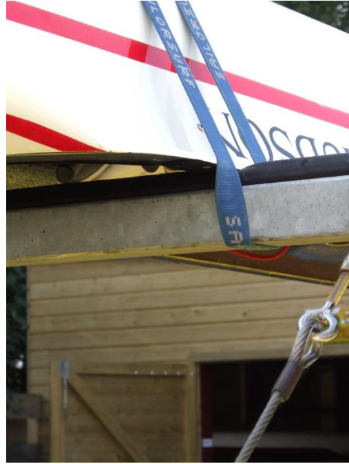
Foto 2: singels zo vastzetten dat singels kunnen spannen (dus niet dubbel om de stelling leggen)
