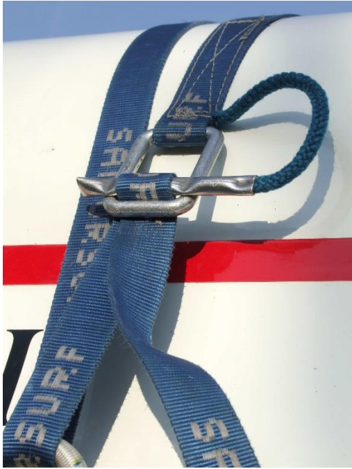
Foto 1: het correcte vastzetten van de sluiting
