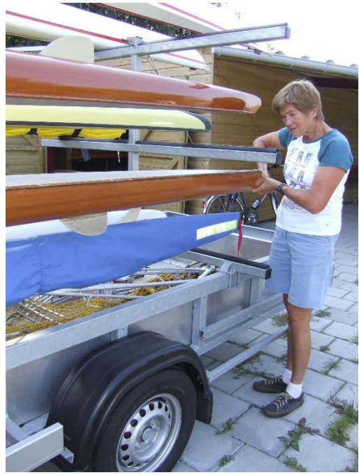
Foto 8: het hangen van een skiff onder de stelling. Let erop dat de boorden niet beschadigen en dat de kiel geen andere boten raakt.
