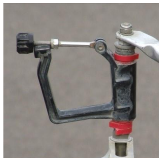
Klikringetjes onder en boven de dol
